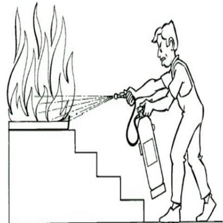
4. Dirigir el chorro a la base de las llamas con movimiento de barrido. En caso de incendio de líquidos proyectar superficialmente el agente extintor efectuando un barrido evitando que la propia presión de impulsión provoque derrame del líquido incendiado. Aproximarse lentamente al fuego hasta un máximo aproximado de un metro
