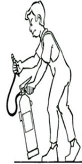
2. Sacar la boquilla de la manguera del extintor y comprobar, en caso que exista, que la válvula o disco de seguridad (V) está en posición sin riesgo para el usuario. Sacar el pasador de seguridad tirando de su anilla.
