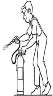
3. Presionar la palanca de la cabeza del extintor y en caso de que exista apretar la palanca de la boquilla realizando una pequeña descarga de comprobación.
