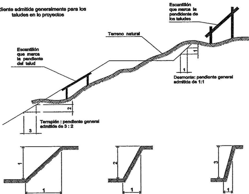
Pendientes máximas de los taludes admitidas en tres tipos de terrenos
