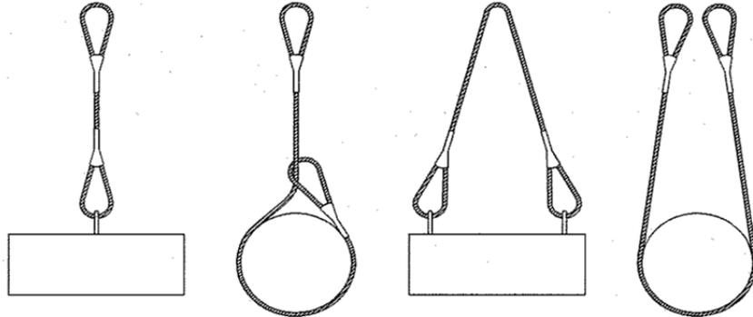
NUNCA SE DEBEN CRUZAR LAS ESLINGAS. SI SE MONTA UNA SOBRE OTRA, PUEDE PRODUCIRSE LA ROTURA DE LA ESLINGA QUE QUEDA APRISIONADA.
